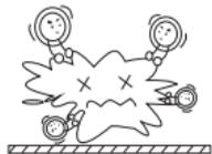
水在超声波的作用下，形成数以万计的微小气泡。
